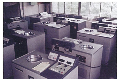
日本脳炎ワクチン精製用超遠心機(昭和41年)
